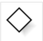
O gateway é conectado ao fluxo através de setas de fluxo de sequência e é representado visualmente por um losango. O símbolo interno do losango identifica a interpretação lógica representada.
